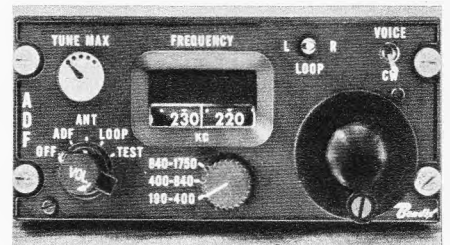
Bild 8. Das Bedienungsgerät zum Bendix-Radiokompaß DAF-73 (Bereich 190 kHz bis 1900 kHz) Foto: Telefunken
